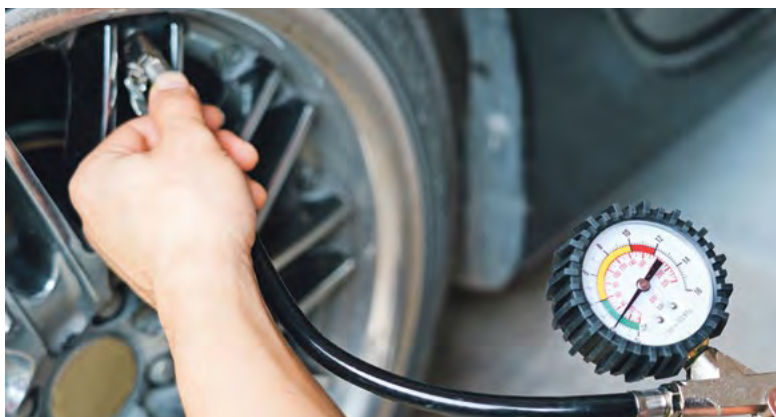
Rapidement fait et vraiment important pour la durée de vie des pneus et la sécurité: la pression des pneus devrait être contrôlée au moins une fois par mois. Photo: iStock
