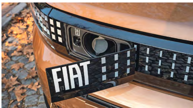
Le câble de recharge en courant alternatif de la Grande Panda est intégré dans la façade et peut être retiré comme un câble de téléphone. Photos: Fiat
