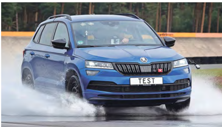
Les tests de pneus, comme ici celui du TCS, évaluent chaque année les pneumatiques. Un critère important est le comportement sur le mouillé. Photo : TCS
