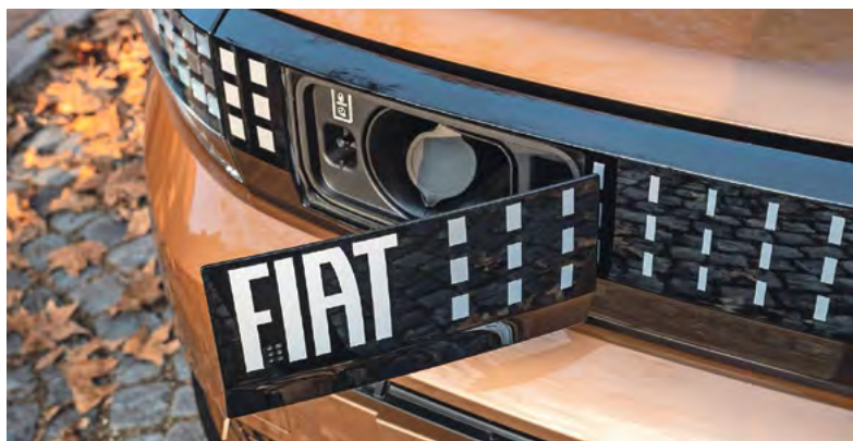
Das Wechselstrom-Ladekabel des Grande Panda ist in der Front integriert und kann wie ein Telefonkabel herausgezogen werden. Fotos: Fiat
