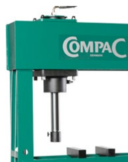
Seitwärts verschiebbarer Presszylinder
